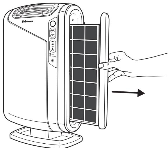
2. Retire los filtros que necesita cambiar.
