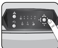
Sélectionner le réglage « open » (ouverture) à l'aide des boutons de navigation du panneau de contrôle. Appuyez sur le bouton « OK ».
