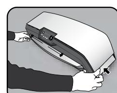
La plastificadora Titan™ tiene soportes de desplazamiento integrados para un movimiento fácil y seguro. Empuje hacia adentro las solapas en ambos extremos de la plastificadora para acceder a ellos.
