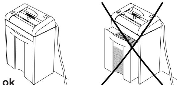
**D** Maschine korrekt im Auffangbehälter bzw. Unterschrank? (A)
