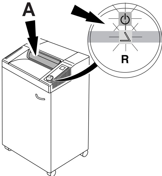
**NL** Automatische stop als de veiligheidsklep (A) geopend wordt (Symbolen ↴ en ⚡ knipperen afwisselend.)
