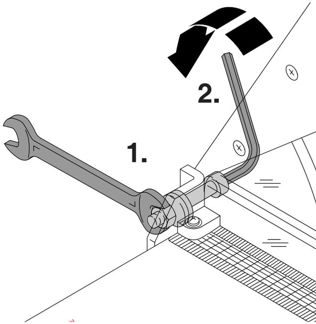
**E** La máquina tiene un **sistema de fricción** en el portacuchillas. Este asegura que el portacuchillas no se pueda mover hacia abajo solo. Si el portacuchillas no está en su posición y se mueve solo, por favor reajustar el sistema de fricción inmediatamente.
