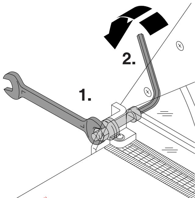
**D** Die Maschine ist mit einer **Friktionseinrichtung** am Messerhebel ausgerüstet. Sie verhindert, daß der Messerhebel sich aus einer angehobenen Stellung selbständig nach unten bewegt. Ist dies dennoch der Fall, so muß die Friktionseinrichtung wie folgt nachjustiert werden:
