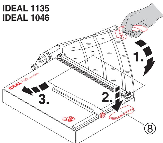
**D** Dann das Papier mit der Handpressung ② pressen und den Schnitt ausführen (bei den Modellen IDEAL 1135 und IDEAL 1046 erfolgt die Pressung automatisch bei Schnittausführung).
