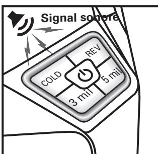
3. Pendant le réchauffement de la plastifieuse, la lumière sur le mode thermique sélectionné se met à clignoter. Une fois la température de plastification appropriée atteinte, l'appareil émettra 3 bips. La plastifieuse est maintenant prête.
