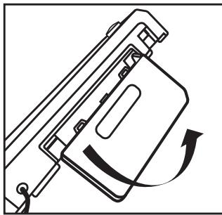
2. Localiser le plateau de sortie qui se trouve sous la plastifieuse (certains modèles uniquement). Ouvrir le plateau en le dépliant en position la plus ouverte.
