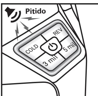
3. Mientras la plastificadora se caliente, la luz del modo térmico seleccionado titilará. Una vez que se alcance la temperatura de plastificado adecuada, sonarán 3 pitidos de aviso. La plastificadora está lista para usar.
