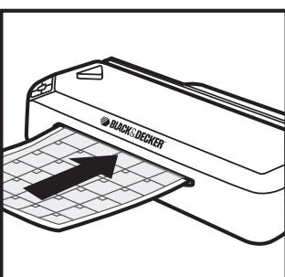
**3.** Inserte el extremo sellado del sobre directamente en la ranura de entrada y guíe el sobre suavemente hacia delante hasta que la máquina lo haga pasar.
