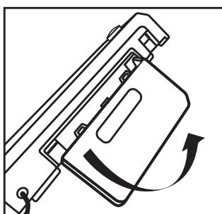
2. Ubique el soporte de salida, que está debajo de la plastificadora (solamente en ciertos modelos). Despliegue el soporte hasta su máxima extensión.
