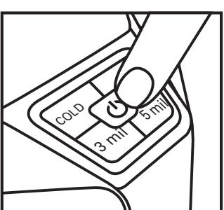
2. Presione el botón de encendido para apagar la plastificadora y desenchufe el cable de alimentación. Espere que la plastificadora se enfrié antes de almacenarla.
