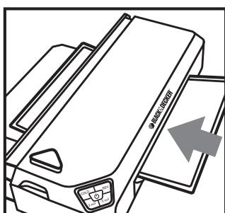
1. Alors que l'appareil est toujours chaud, insérer la feuille de nettoyage fournie dans la plastifieuse. La feuille est conçue pour éliminer tout résidu d'adhésif qui peut s'écouler sur les rouleaux pendant la plastification. Elle permettra également d'obtenir une bonne performance constante.
