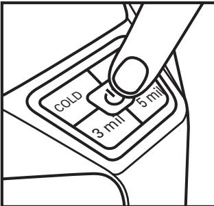
**1.** Allumer la plastifieuse en appuyant sur la touche d'alimentation du panneau de commande. L'appareil démarre automatiquement en mode froid et la touche COLD (Froid) demeure allumée.
