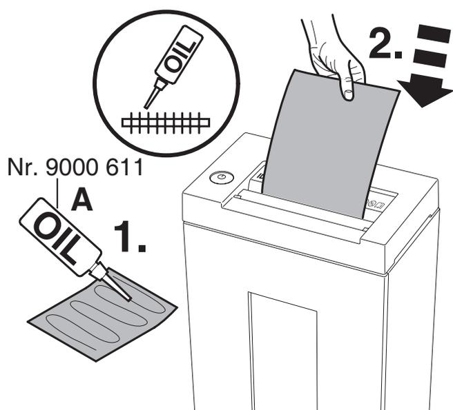
**ES** Si la capacidad de hojas se reduce o si la receptáculo está llena, recomendamos que lubrique el mecanismo destructor! (mirar dibujo) Para el modelo de corte en tiras utilizar el bote de aceite (**A**) Para el modelo de corte en partículas, utilizar el bote de aceite o las hojas con aceite (**B**) Consultar las referencias de ambos artículos (**A** y **B**) en la página 29.
