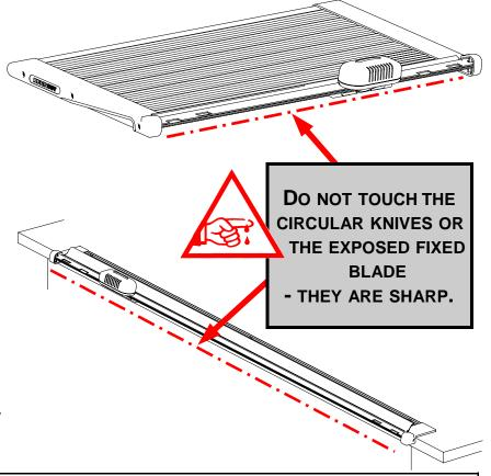
IT IS ESSENTIAL THAT THE TABLE OR WORK BENCH SURFACE ON WHICH THE CUTTER IS INSTALLED IS FLAT. IF THE SURFACE IS BOWED IT CAN AFFECT THE STRAIGHTNESS OF THE BLUE PLASTIC CLAMP STRIP. ENSURE BEFORE USE THE CLAMP STRIP IS CLEAR OF THE CUTTING LINE.
