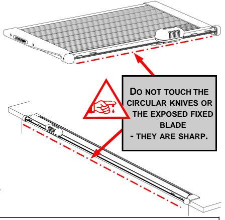
IT IS ESSENTIAL THAT THE TABLE OR WORK BENCH SURFACE ON WHICH THE CUTTER IS INSTALLED IS **FLAT**. IF THE SURFACE IS BOWED IT CAN AFFECT THE STRAIGHTNESS OF THE BLUE PLASTIC CLAMP STRIP. ENSURE BEFORE USE THE CLAMP STRIP IS CLEAR OF THE CUTTING LINE.
