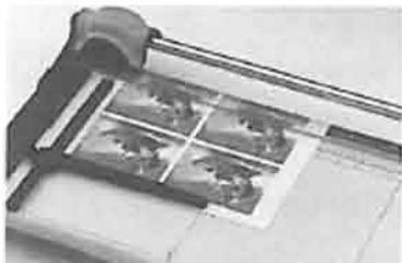
1. Placez le support sous le dispositif de protection de coupe transparent.
