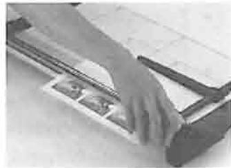
3. Zum Schneiden der Medien Klinge herunterdrücken und schieben. Zur Arretierung den Schneidkopf ganz nach links oder nach rechts schieben.
