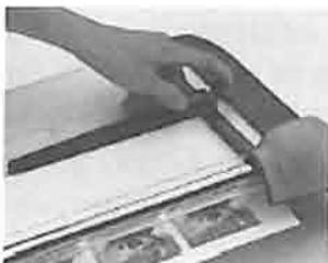
2. Ajustez le guide de support sur la position appropriée. Peut être retiré pour des applications plus grandes.
