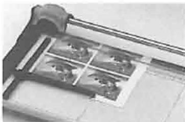
1. Coloque los medios debajo de la protección de corte transparente.
