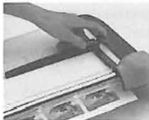
2. Medienführung in die richtige Position bringen. Kann bei größeren Anwendungen entfernt werden.
