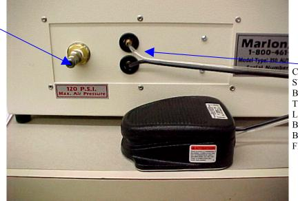
CONNECT THE FOOT SWITCH TO THE CRIMPER BY INSERTING THE CLEAR TUBE INTO THE TOP PUSH LOCK FITTING AND THE BLACK TUBE INTO THE BOTTOM PUSH LOCK FITTING
