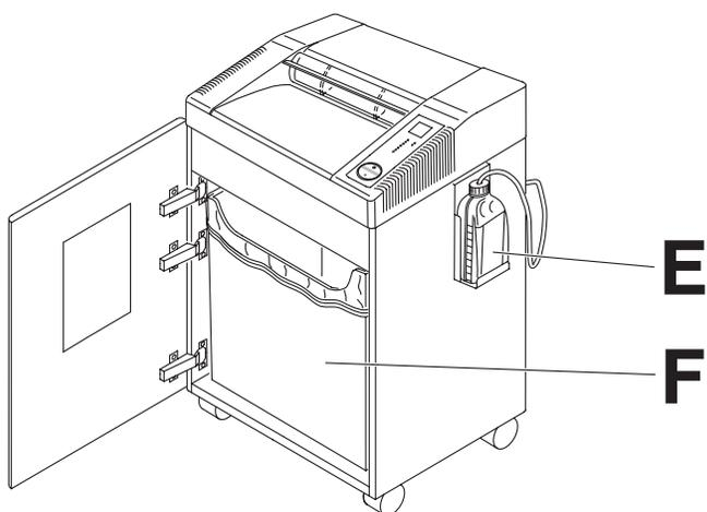
**E** Para las versiones IDEAL 3105; 4005 coupe fibres, IDEAL 3105 C/C; 4005 C/C 2x15 y IDEAL 3105 C/C; 4005 C/C 4x40, inserte la bolsa de plástico incluida, en la estructura extraíble para el depósito de residuos. (1.)
