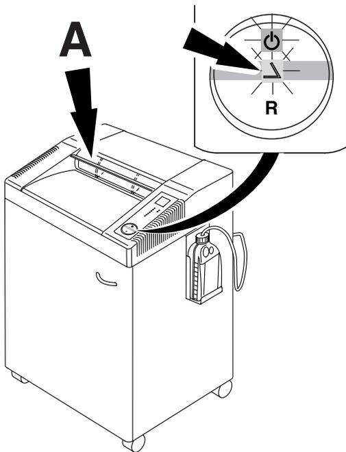
**D** Autom. Stopp wenn Sicherheitsklappe (A) geöffnet wird (Symbole  $\triangle$  und  $\text{⏻}$  blinken abwechselnd).
