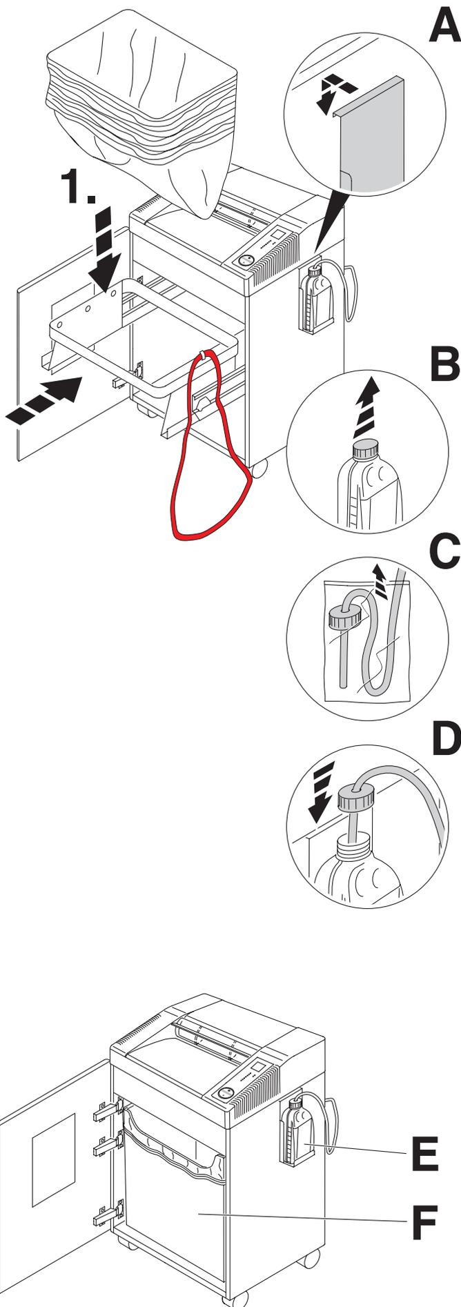
**D** Beim IDEAL 3105, 4005 Streifenschnitt, IDEAL 3105 C/C, 4005 C/C 2x15mm und IDEAL 3105 C/C, 4005 C/C 4x40mm beiliegenden Plastiksack in ausziehbare Aufhängevorrichtung einsetzen (1.). IDEAL 4005 M/C 0,8x12mm und IDEAL 3105 SM/C, 4005 SM/C haben einen Behälter mit Plastiksack (F).
