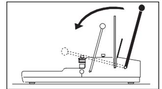
Stanzhebel nach vorn bis zum Anschlag drücken und wieder ganz zurückführen Maschine mit der anderen Hand halten.
