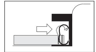
Bindeelement muß senkrecht an der Rückwand des Schließbalkens stehen
