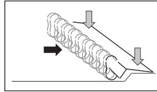
**Bindeelemente unter die Klemmleiste schieben**
