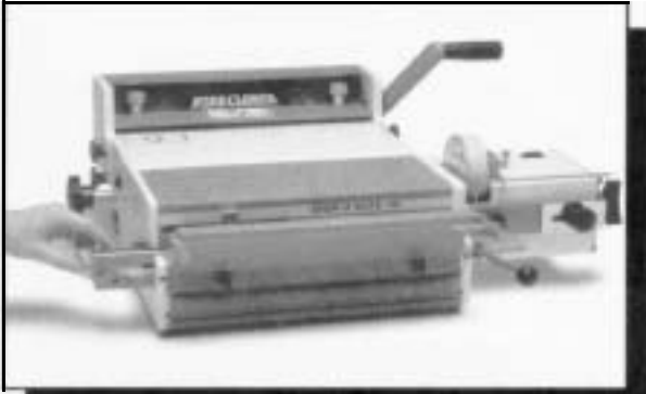
THE OD 4000 PUNCH WITH OD 4300 PLASTIC COIL INSERTER MODULE AND THE OD 4200 WIRE CLOSER MODULE
